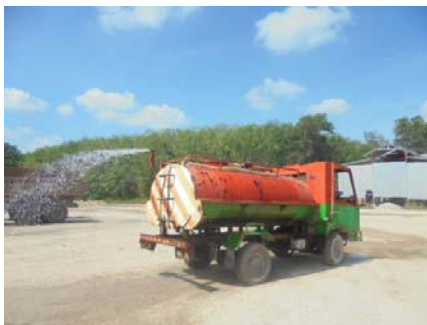
รูปที่ 2-28: การฉีดพรมน้ำบริเวณโรงแต่งแร่
