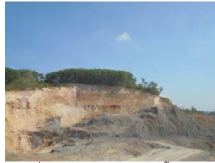
รูปที่ 2-17: การทำเหมืองแบบชันบันได
